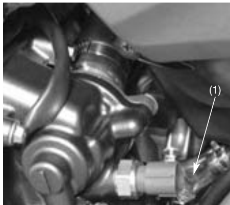
(1) Tubo de drenaje
