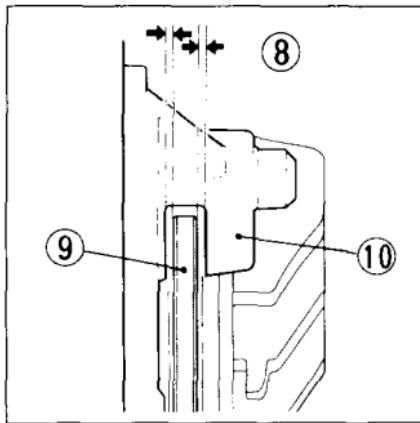
Pincer l'étrier droit sur le disque en faisant attention à ne pas endommager les plaquettes de frein. Reposer les boulons de montage d'étrier et les serrer à un couple de serrage de 27 N·m (2,7 kg-m).
