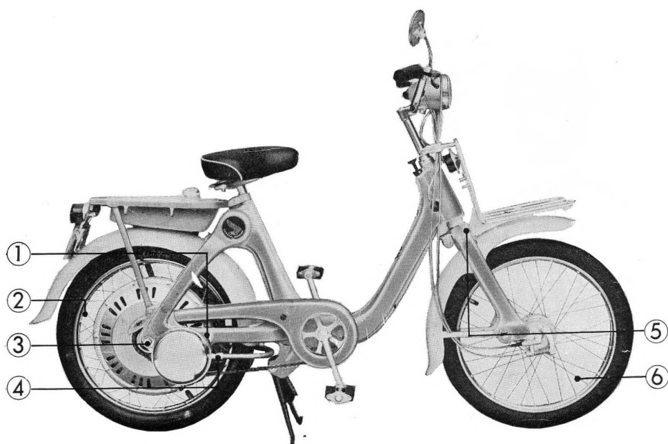
Figure 1-25 : ① boulon 6×14 ② rayon ③ écrou du moyeu de roue arrière ④ bride du silencieux ⑤ écrou de 6×14 (deux) ⑥ rayon
