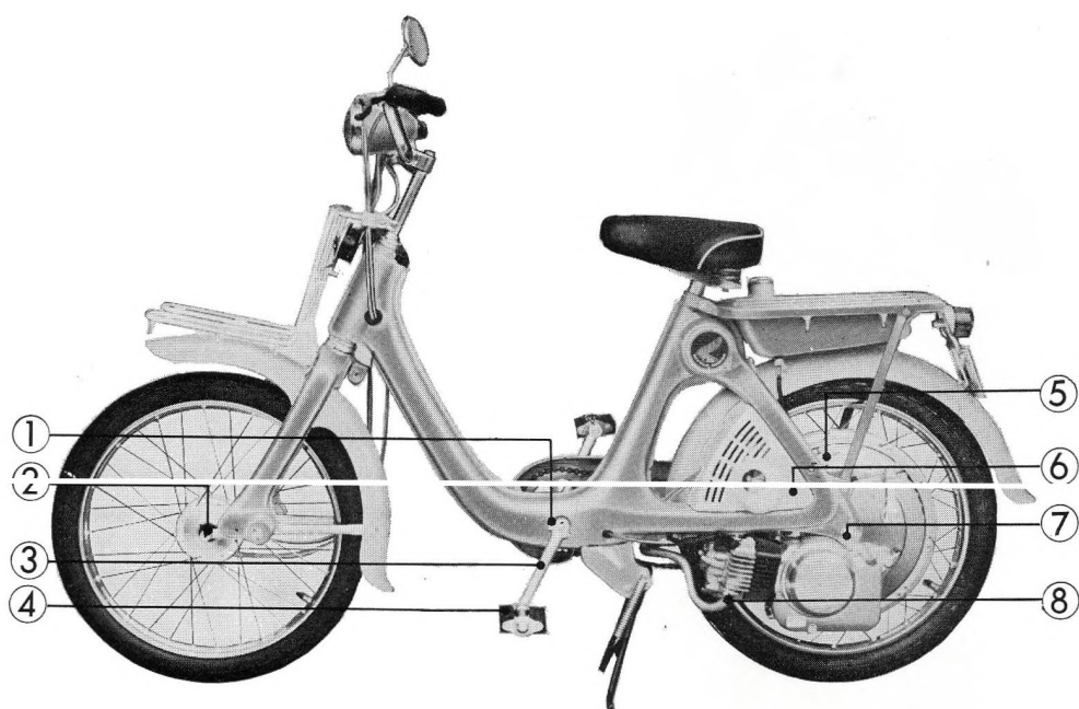
Figure 1-24 : ① goupille de manivelle ② écrou du moyeu de roue avant ③ manivelle ④ pédale ⑤ bras de poussée arrière ⑥ couvercle de carburateur ⑦ écrou du moyeu de roue arrière ⑧ tubulure d'échappement
